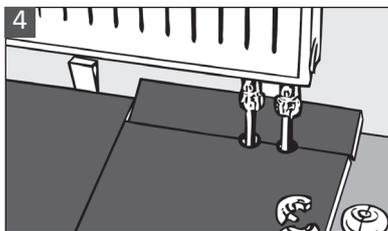
**4** Bei Heizungsrohrdurchbrüchen die Diele am Stoß ausklinken und mit Heizkörperrossetten abdecken.
