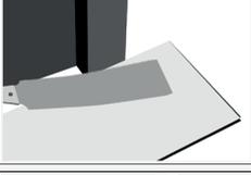
Feste Bauteile wie Türzargen müssen gekürzt werden, damit der **SAMOA-FERTIGFUBBODEN** darunter liegen kann. Es darf nicht anstoßen. Vor der Kürzung der Türzarge muß geprüft werden, dass die Türzarge dauerhaft befestigt ist. Ein Absacken der Türzarge könnte die Bewegungsfreiheit des **SAMOA-FERTIGFUBBODEN** beeinträchtigen. Aufgrund dessen sollte auch auf eine Silikonfuge verzichtet werden!
