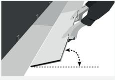
Der **SAMOA-FERTIGFUBBODEN** wird üblicherweise nicht geleimt, sondern trocken verlegt. Dabei werden die einzelnen Dielen mit der Feder der Langkante in die Nut der davor liegenden Diele in einem Winkel von 20-30° eingedreht, indem man die Diele auf und ab bewegt. Die Langkante kann zusätzlich mit der **KWG Schlagleiste (Art.-Nr.: 840030)** zusammen geklopft werden. Bitte achten Sie vor der Verlegung darauf, dass Nut und Feder frei von Spänen oder sonstigen Verunreinigungen sind.
