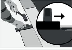
Zum Zusammenfügen der Kurzseite schlagen Sie diese mit der **KWG Schlagleiste (Art.-Nr.: 840030)** an der Nutseite vorsichtig ineinander. Schlagen Sie nie die Federseite, da diese sonst beschädigt werden kann. Bei zu starkem Zusammenklopfen kann sich die Korkauflage im Kantenbereich hochdrücken. Für die letzte Diele in einer Reihe benötigen Sie ein Zugeisen zum Zusammenfügen.
