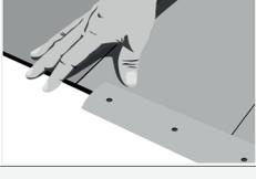
Übergänge zwischen dem **SAMOA-FERTIGFUBBODEN** und anderen Bodenbelägen sowie zwei aneinanderliegenden Räumen müssen generell mit einem Parkettprofilssystem abgedeckt werden.
