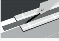
Die letzte Dielenreihe wird in die richtige Breite gesägt. Dabei ist auf die Dehnungsfuge zu achten! Danach wird die Dehnungsfuge mit einer Fußleiste abgedeckt. Sie darf allerdings nicht zu dicht auf dem **SAMOA-FERTIGFUBBODEN** liegen, um die Bewegungsfreiheit des Bodens nicht zu beeinträchtigen.
