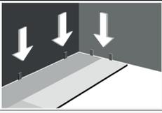
Eine Dehnfuge von mind. 10 mm zwischen dem **SAMOA-FERTIGFUBBODEN** und der Wand sowie allen festen Bauteilen wie Heizungsrohre, Türzargen usw. muss zwingend eingehalten werden. Raumlänge bis 10 m = 10mm Dehnfuge; bei einer Raumlänge ab 10 m je weiteren Meter 1 mm Dehnfuge zusätzlich einhalten (maximale Raumgröße 15 m Länge und 10 m Breite).
