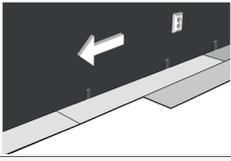
Bei den Dielen der ersten Reihe wird die Feder der Langkante mit einer geeigneten Säge abgeschnitten, so dass die Schnittkante zur Wand zeigt. Die folgenden Dielenreihen sollen mind. 1/3 versetzt verlegt werden. Optimal ist die Verlegung im Halbverband (mind 30 cm).
