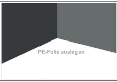
Es ist zu empfehlen an einer geraden Wand, längs zum Lichteinfall, von rechts nach links zu beginnen. Eine Dampfsperre ist bei allen mineralischen Untergründen unerlässlich. Legen Sie dazu eine mindestens 0,2 mm starke PE-Folie unter den **SAMOA-FERTIGFUBBODEN**, wobei die Stoßkanten ca. 20 cm überlappen und abgeklebt werden müssen. An den Wänden ist die Folie ca. 3 cm hochzuziehen. Wir empfehlen Ihnen die Übergänge mit einem Klebeband abzukleben.
