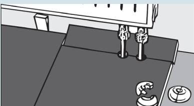
**5** Bei Heizungsrohrdurchbrüchen die Dielle am Stoß ausklinken und mit Heizkörperrosetten abdecken.
