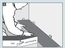
2 Beginnen Sie mit der Verlegung links in einer Ecke des Raumes. Legen Sie die erste Diele so, dass die lange Nutseite zur Wand zeigt (siehe Bild).
