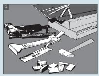
1 Zur optimalen Verlegung benötigen Sie folgende Werkzeuge: Zollstock, Bleistift, Cuttermesser, Fuchsschwanz, ZIRO-Schlagklotz, Setzlatte, Abstandskeile und Gummihammer.
