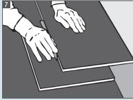
Tinpassen der letzten Dielenreihe: Legen Sie exakt auf die zuletzt verlegte Dielenreihe die nachzusägende Diele. Dann zeichnen Sie mit Hilfe einer weiteren Diele den Längsschnitt an. Durch diese Art des Anzeichnens bleibt genügend Abstand zur Wand um die letzte Reihe mittels Zugeisen einzuwinkeln.
