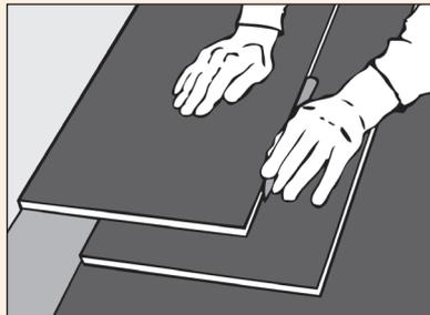
**7** Einpassen der letzten Dielenreihe: Legen Sie exakt auf die zuletzt verlegte Dielenreihe die nachzusägende Diele. Dann zeichnen Sie mit Hilfe einer weiteren Diele den Längsschnitt an. Durch diese Art des Anzeichnens bleibt genügend Abstand zur Wand, um die letzte Reihe mittels Zugeisen einzuwinkeln.
