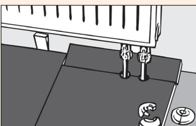
**5** Bei Heizungsrohrdurchbrüchen die Diele am Stoß ausklinken und mit Heizkörperrosetten abdecken.
