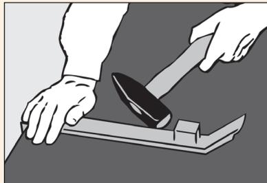
**8** Die letzte Dielenreihe wird mit dem Zugeisen längsseitig und mit dem ZIRO-Schlagklotz stirnseitig zusammengetrieben.
