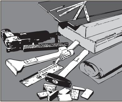
**1** Alles bereit? PE-Folie und Klebeband. Als Werkzeug benötigen Sie: Zollstock, Bleistift, Stichsäge, Fuchschwanz, Fäustel, Setzlatte, Zugeisen, ZIRO-Schlagklotz, Abstandskeile.
