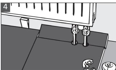
**4** Bei Heizungsrohrdurchbrüchen die Diele am Stoß ausklinken und mit Heizkörperrosetten abdecken.
