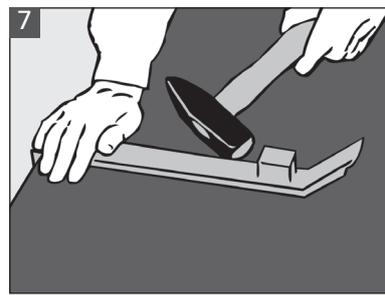
**7** Die letzte Dielenreihe wird mit dem Zugeisen längsseitig und mit dem Schlagklotz stirnseitig zusammengetrieben.
