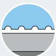
2 **Antislip Additiv** sorgt für eine rutschhemmende Oberflächenstruktur und erfüllt die erhöhten Anforderungen der Berufsgenossenschaft (BGR 181, DIN 51130).
